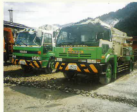
コンクリートポンプ車
